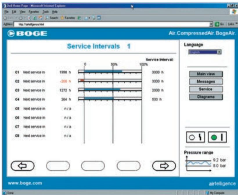
Постоянное обновление основной информации и операционных параметров на компьютере в режиме реального времени, исчерпывающее отображение параметров в web - браузере.
